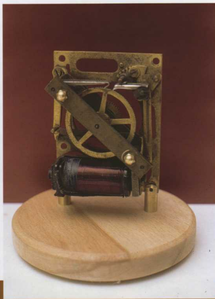
Reloj secundario o receptor de impulsos eléctricos sincronizados por cable (principios del siglo XX)
