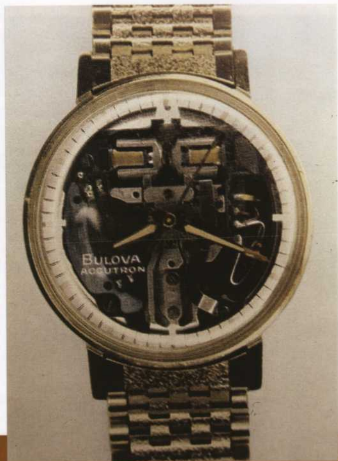
Reloj de pulsera con oscilador de diapásón (Bulova Accutron)
