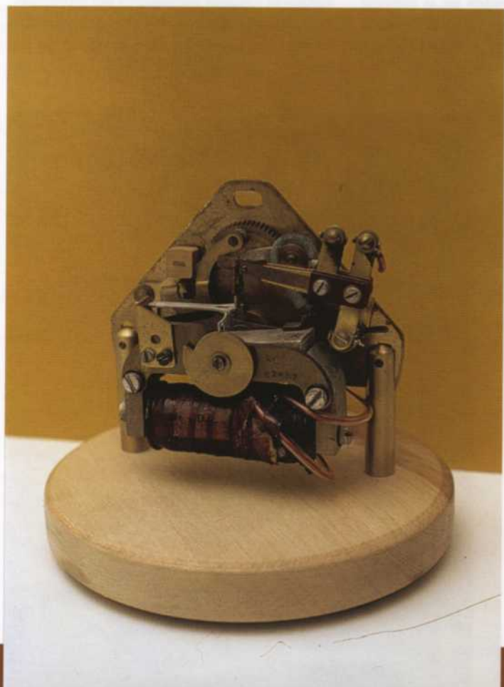
Reloj secundario con mecanismo de control periódico desarrollado por IBM
