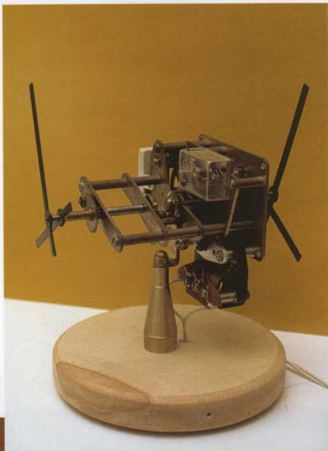
Mecanismo de un reloj de volante con indicadores en doble cara y motor para el remontaje del muelle real.
