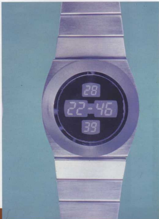
Primer reloj de pulsera de cuarzo con indicación por diodos de cristal líquido (1972)
