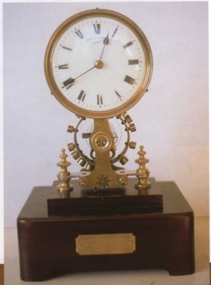
Reloj Eureka (1906) con volante mantenido electromagnéticamente.
